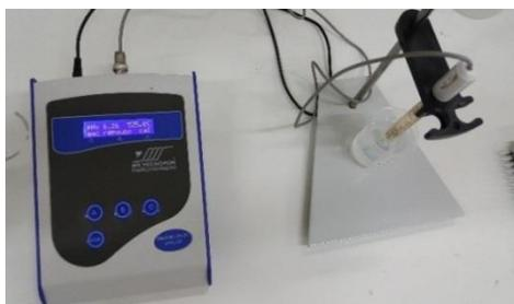
**Figura 3:** Calibração pHmetro
