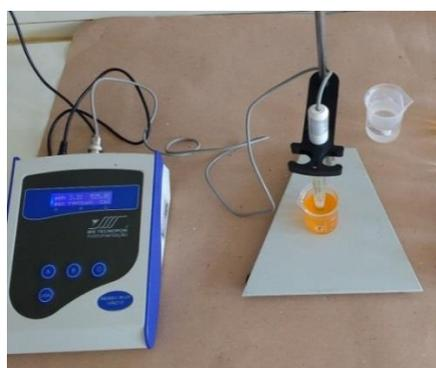
**Figura 5:** Verificação do pH por meio do pHmetro Fonte: Elaboração dos autores deste artigo
