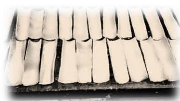
**Figura2** - Telhas com pó de vidragem
